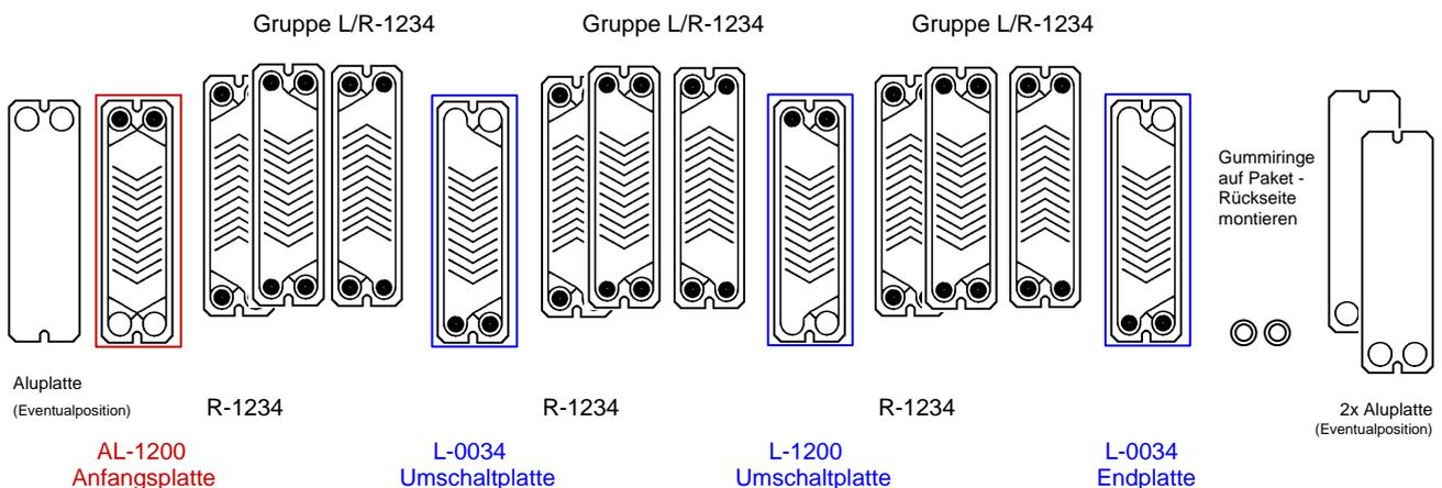
Aluplatten werden nicht bei allen Modellen verwendet (Eventualposition), das Pressmass ist entsprechend anzupassen!
